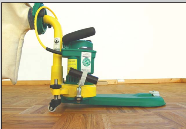
Abb. 7 Mit dem langem Vorsatz lässt sich die FLIP® besonders gut für den Feinschliff verwenden.
