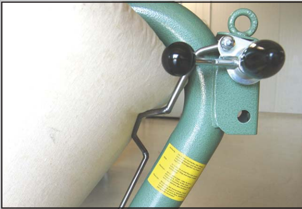
Abb. 20 Bedienungselemente für Linkshänder an der HUMMEL®
