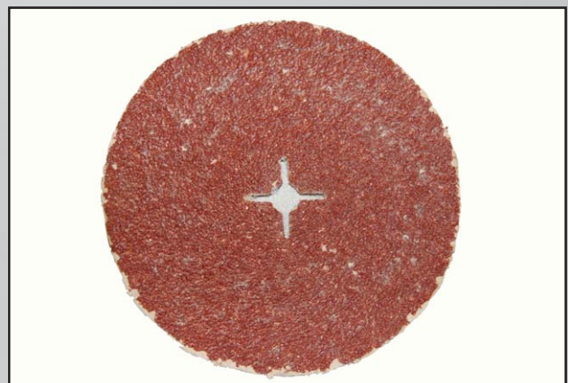
Abb. 16 Geschraubte Korund-Schleifscheibe mit schlechter Qualität.
