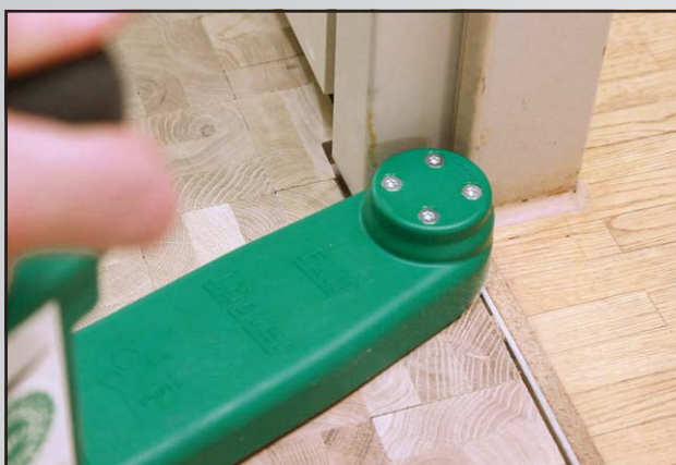
Abb. 5 Optimaler Einsatz des FLIP®-Eckenvorsatzes.
