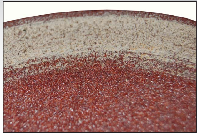
Abb. 15 Zugesetzte geschraubte Korund-Schleifscheibe mit kurzer Standzeit.
