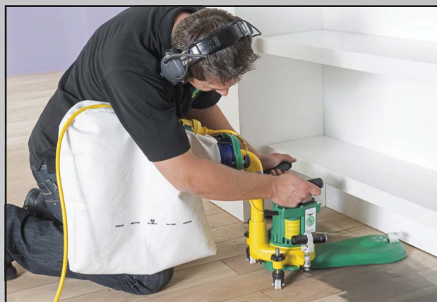
Abb. 6 FLIP® mit langem Vorsatz beim Schleifen unter einem Regal.
