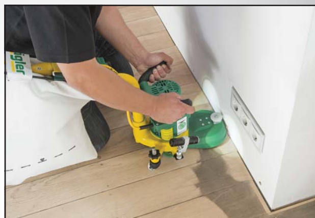
Abb. 4 Die FLIP® mit kurzem Vorsatz und zusätzlichen Arbeitslampen.
