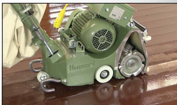
Abb. 6 Einstellen der Frästiefe.
