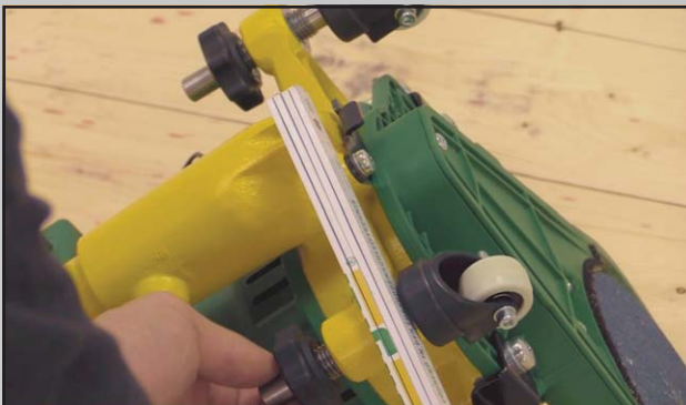
Abb. 9 Einstellen der Laufräder mit einem Meterstab.
