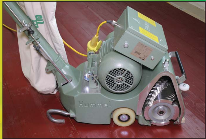
Abb. 2 Fräswalze IGEL im eingebauten Zustand.
