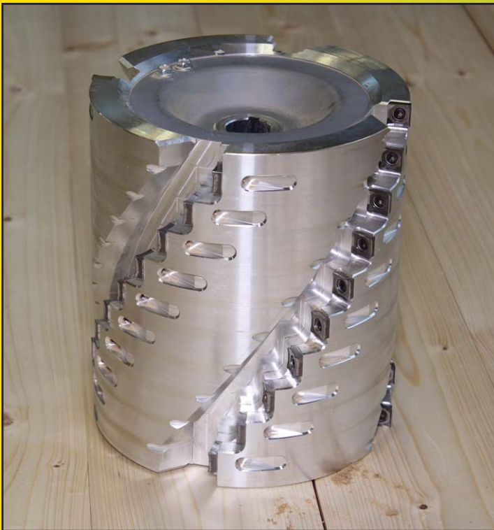
Abb. 1 Wendeschneidplatten der Fräswalze IGEL.
