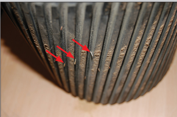
Abb. 3 Metallsplitter stecken im Schleifwalzenbelag
