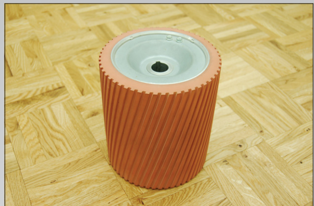
Abb. 12 Schleifwalze mit hartem Gummibelag für astreiches Weichholz
