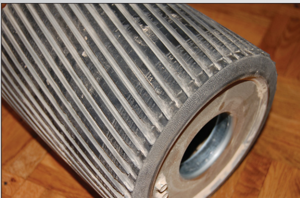
Abb. 7 Stark verschlissenes Schleifwalzenprofil (8 Jahre alt)
