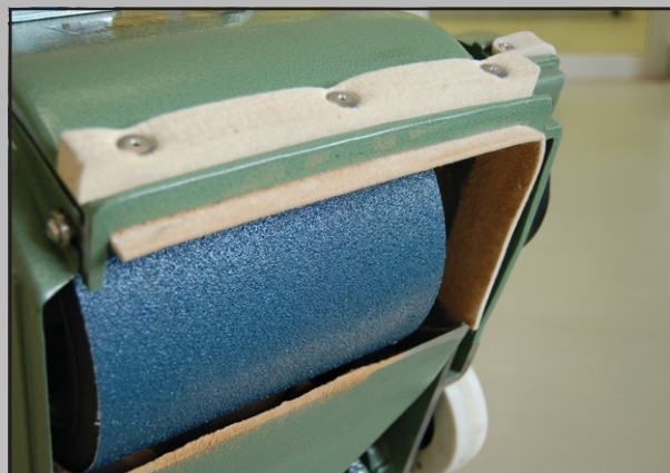
Abb. 12 Neue Dichtfilze reduzieren die Holzstaubbelastung
