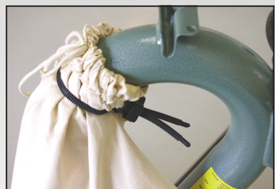
Abb. 4 Staubsack mit MultiClip befestigt
