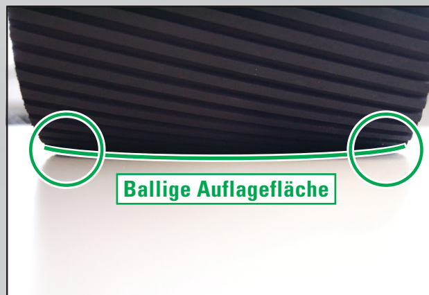
Abb. 7 Balligkeit einer neuen LÄGLER®-Schleifwalze
