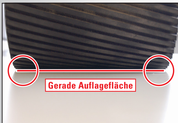
Abb. 6 Zylindrische Form einer aufbereiteten Schleifwalze
