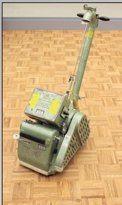
Abb. 1 Nachhaltige Weiterentwicklung der Bandschleifmaschine HUMMEL® (Baujahre 1970, 1995, 2015).
