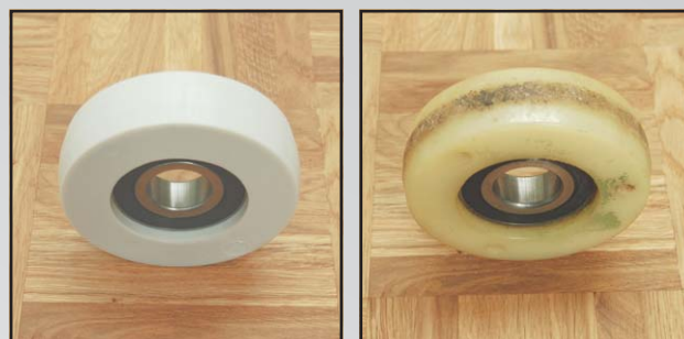
Abb. 9 Zwei Radsätze (neu + alt) sind für das Schleifen verschmutzter Böden hilfreich.
