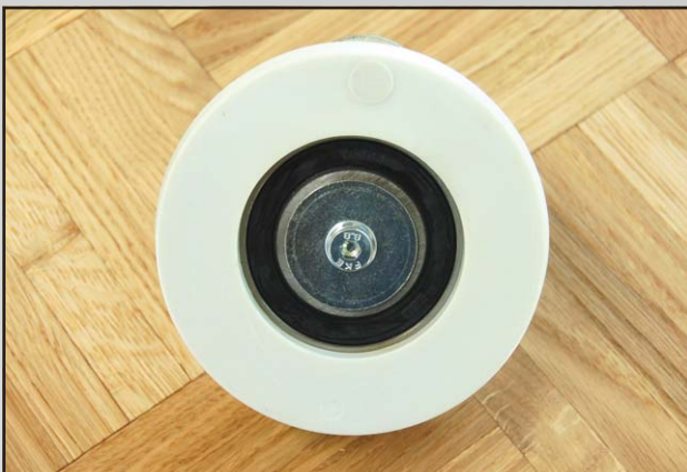
Abb. 3 Aktueller Seitenradtyp der HUMMEL® - schnell und einfach zu wechseln.
