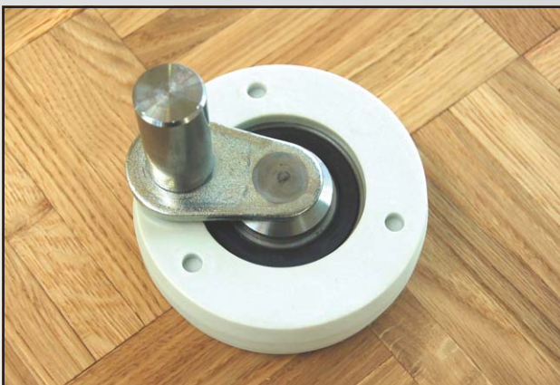
Abb. 4 Aktueller Seitenradtyp komplett mit Radhebel.
