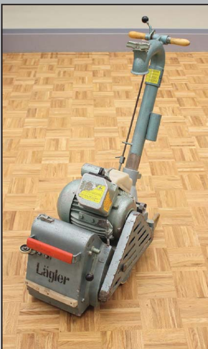
Abb. 1 Nachhaltige Weiterentwicklung der Bandschleifmaschine HUMMEL® (Baujahre 1970, 1995, 2015).
